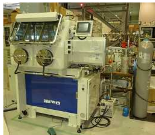
ガス循環精製機付真空式グローブボックス装置 (株式会社美和製作所製)
